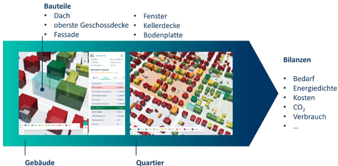
Abbildung 5: Schematische Darstellung des digitalen Gebäudemodells (ENEKA)
