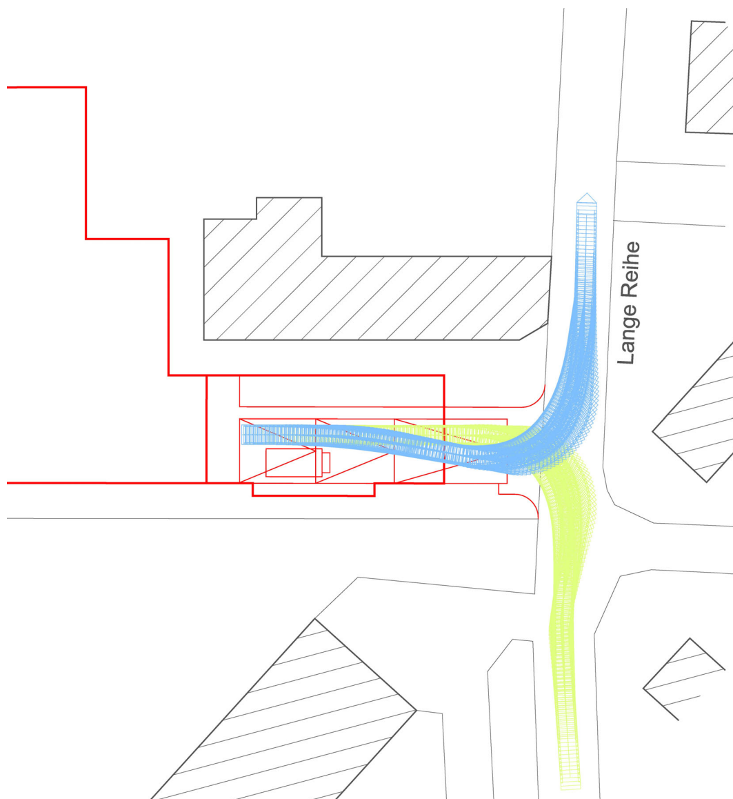
Bild 13: Schleppkurven des Lieferverkehrs
